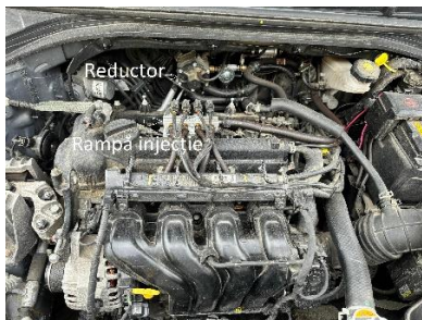
Fig. 4. Reductor și rampă de injecție
